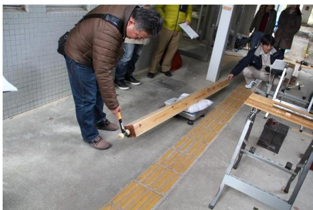
写真6：打撃法による動的ヤング係数の測定
