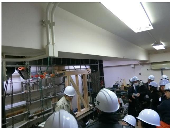
写真 9：片筋交い耐力壁の载荷実験の様子
