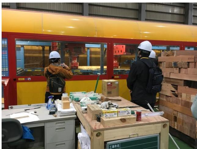
写真 5：大断面の加工が可能なプレカット機械（フンデガー社 K2i）
