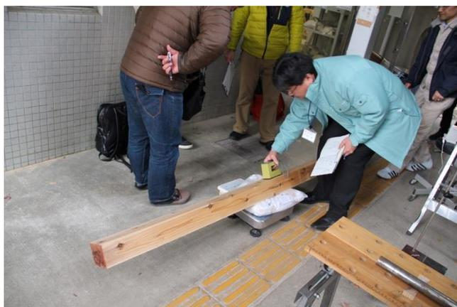
写真 7：高周波式含水率計による含水率測定実習
