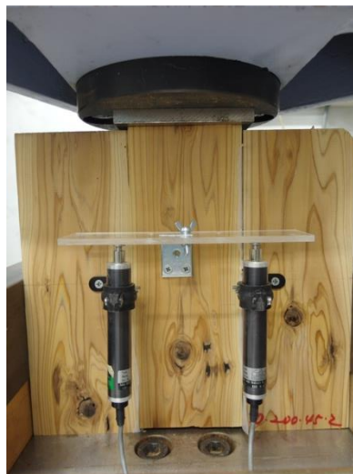
長ビスの打込み条件の検討に関する実験概要 (左: 実験のセットアップ図、右: 実験終了時の様子)
