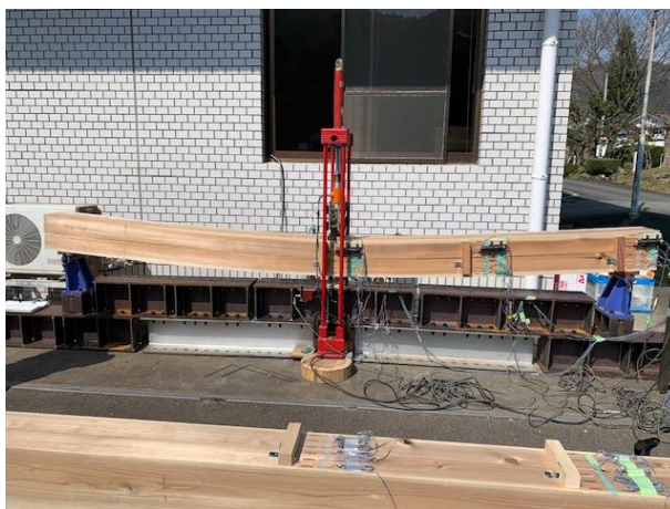
3点曲げ試験によって変形した組立柱
