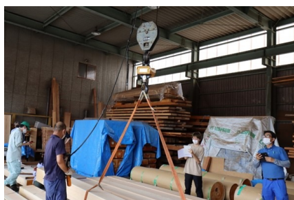
▼強度推定アプリを活用し、ヒノキ材の強度性能評価（非破壊での強度測定等）をしている様子 左写真・下写真 (研究代表者：神代圭輔准教授(生))
